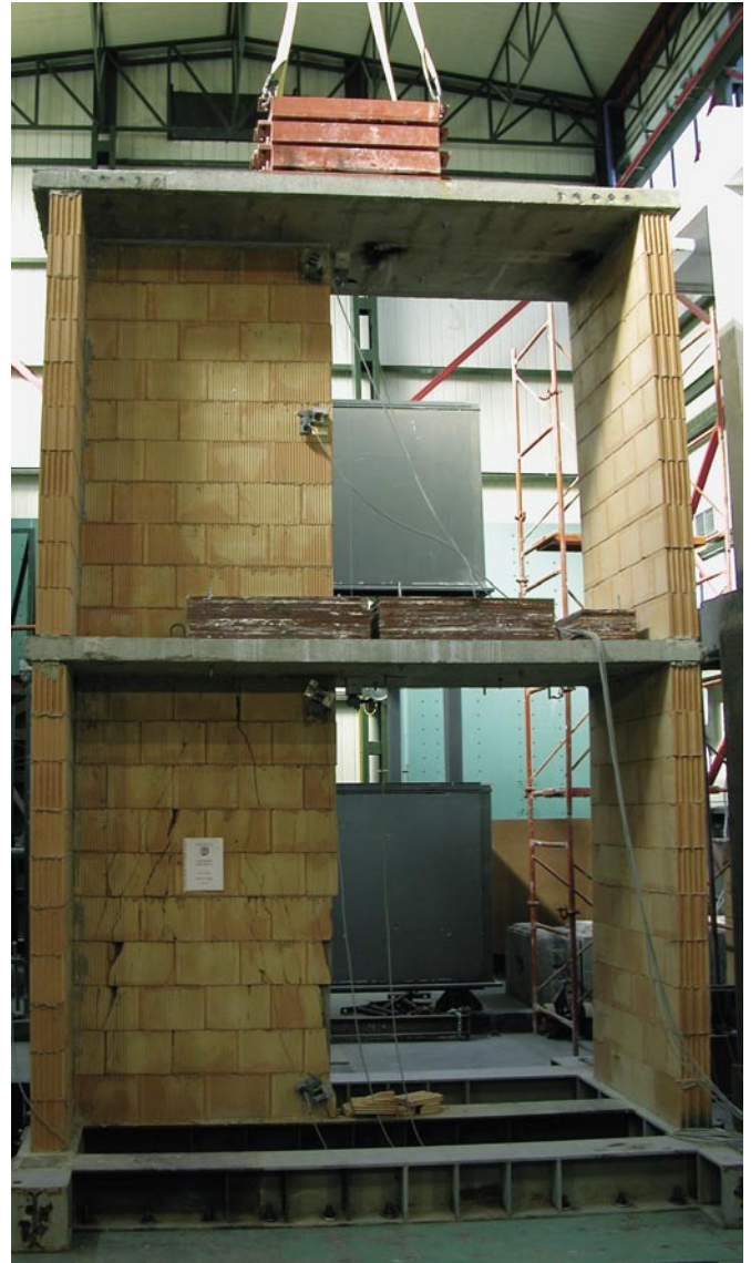
Bild 6: Prüfkörper mit Schubwänden aus Hochlochziegeln und Füllziegeln
